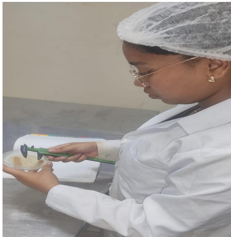
Figura 8. La autora realiza la medición del halo de inhibición presente en la placa de cultivo, utilizando el calibrador milimétrico.
